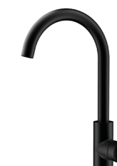
IN 915 BK_EASY • Robinet de cuisine à bec haut • Bec pivotant/Aérateur anti-calcaire • Cartouche de 35 mm avec disques en céramique de haute résistance/Contrôle de la température très précis • Plus grande sensibilité de manipulation avec des mouvements plus fluides • Système de fixation Easy-Quick • Tuyaux flexibles certifiés 3/8e
